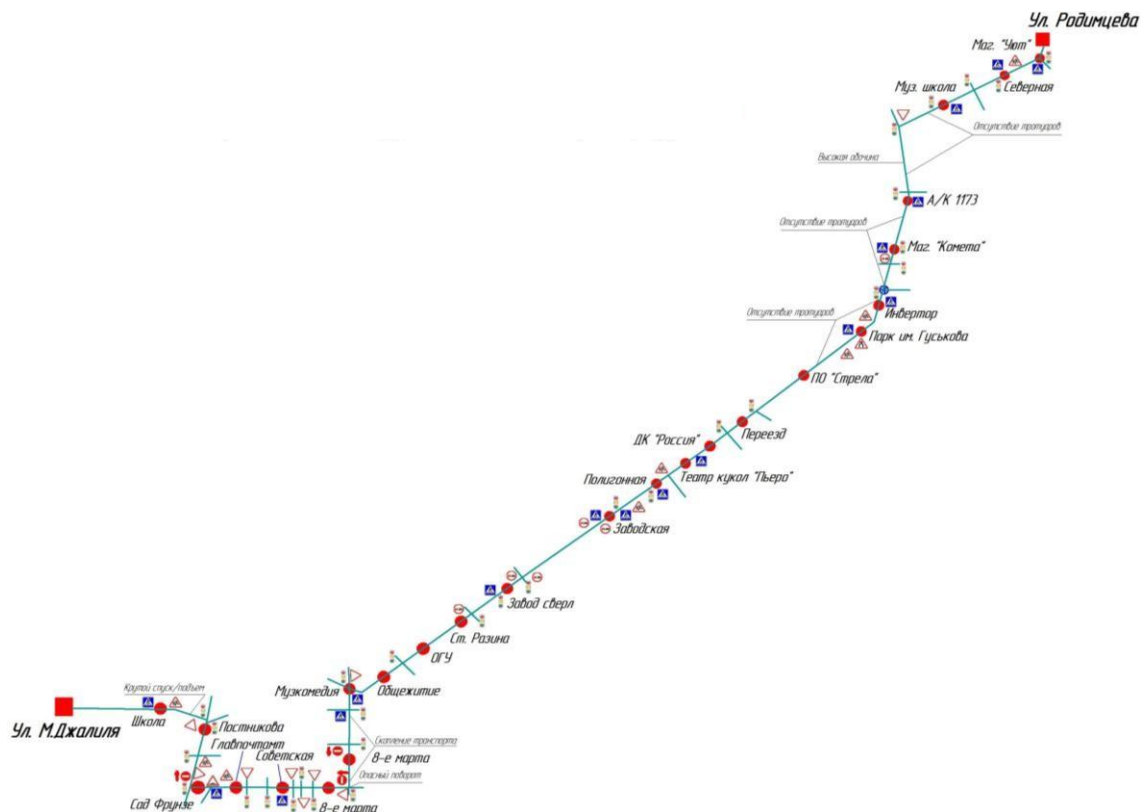
Рисунок 4.5 – Схема опасных участков троллейбусного маршрута №12
