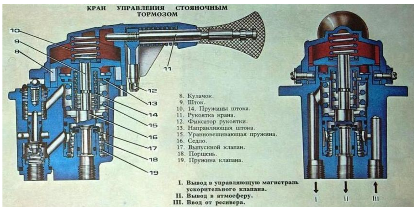
Рисунок 7.2 - Кран управления стояночным тормозом
