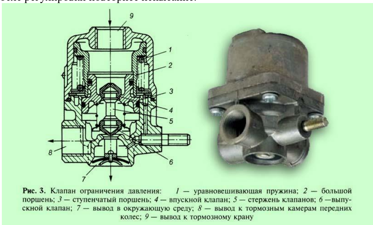
Рисунок 8.1 - Клапан ограничения давления:
