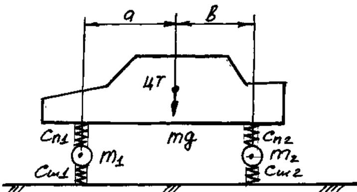
Рис.7– Схема подвески автомобиля
