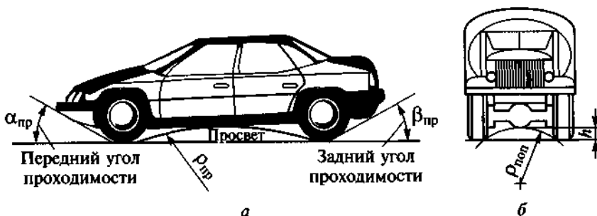
Рис. 8.1. Геометрические показатели проходимости автомобиля: а – легковой автомобиль, вид сбоку; б – грузовой автомобиль, вид спереди
