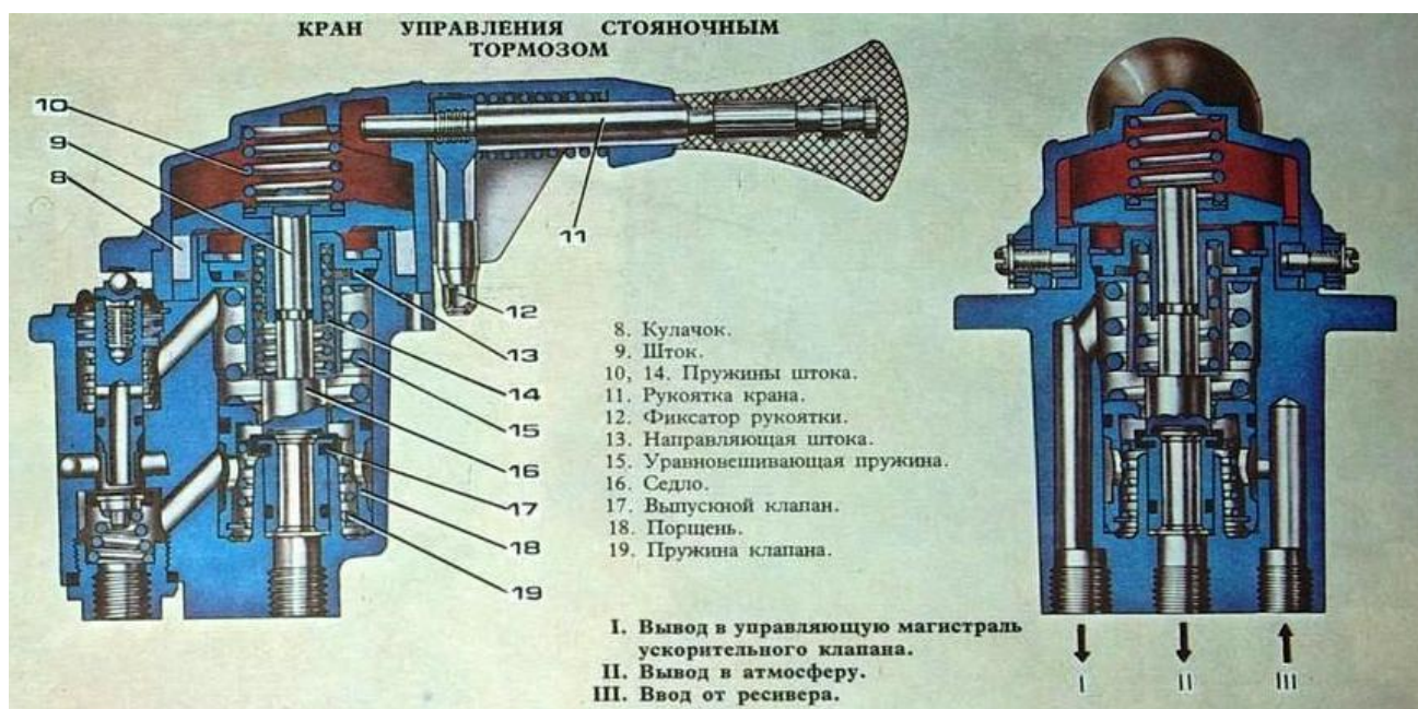
Рисунок 7.2 - Кран управления стояночным тормозом
