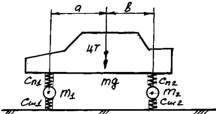
Рис.7– Схема подпрессоренного автомобиля
