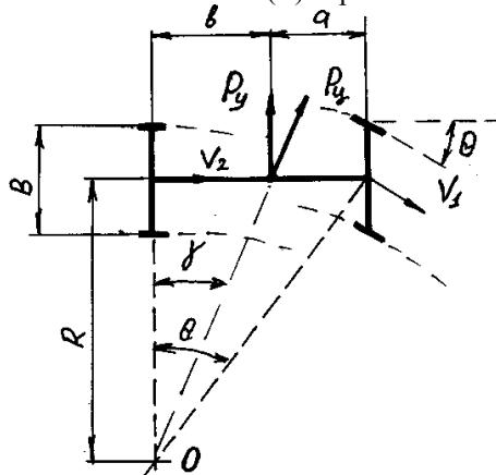
Рис.4 – Схема движения автомобиля на повороте
