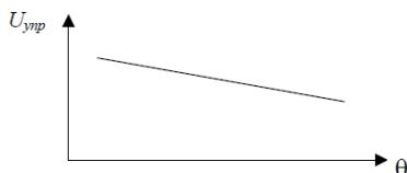
Рисс.5 – График зависимости среднего угла поворота управляемых колес от критической скорости по условиям управляемости
