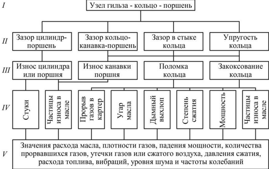
I - объект; II - структурные параметры; III - неисправности; IV - диагностические параметры; V - значения диагностических параметров
