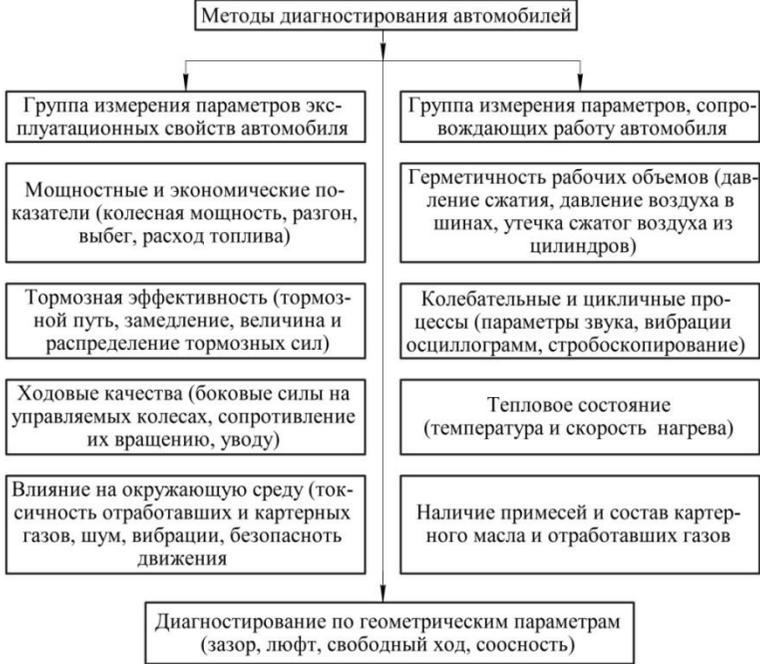
Схема алгоритма диагностирования агрегата автомобиля
