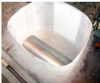
Рис 21. Охлаждение гильзы в ванне с жидким азотом
