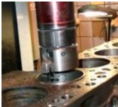
Рис 24. Подрезка выступающей части гильзы
