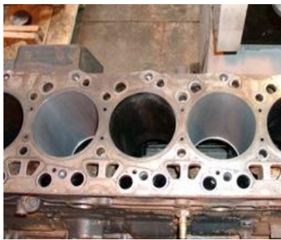
Рис 20. Обработка цилиндров «через один»
