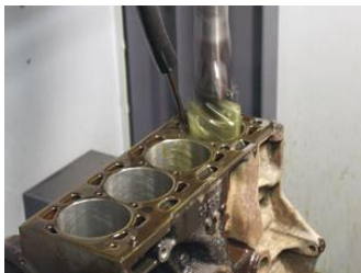
Рис 6. Хонингование цилиндра ДВС
