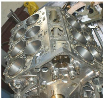
Рис 12. Блок цилиндров с установленными гильзами
