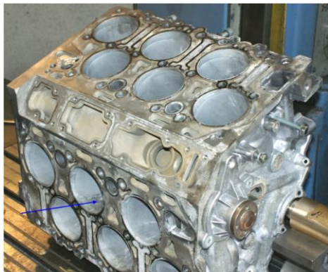
Рис 9. Износ и задиры поверхности цилиндров (указан стрелкой).
