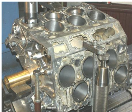
Рис 13. Растачивание отверстий цилиндров
