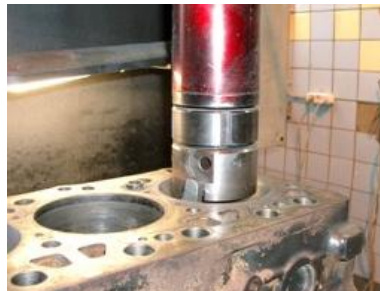
Рис 18. Предварительная расточка блока цилиндров
