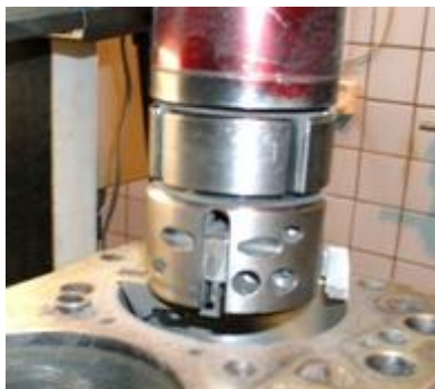
Рис 19. Выполнение фаски для центрирования и установки гильзы
