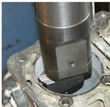
Рис 11. Обработка блока цилиндров под ремонтные гильзы
