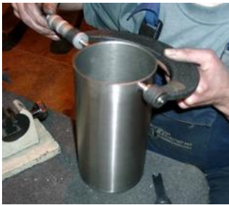
Рис 17. Измерение геометрических параметров гильзы
