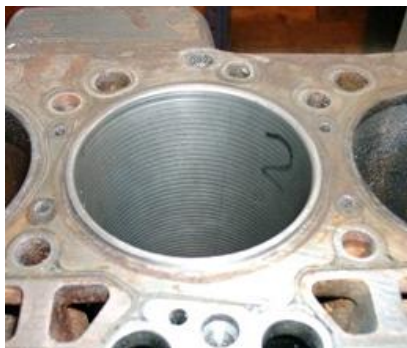
Рис 23. Выступание гильзы относительно плоскости разреза с головкой блока
