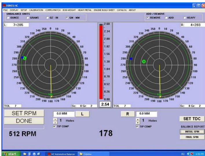
Рис. 5. Значения остаточного дисбаланса после проведенной балансировки
