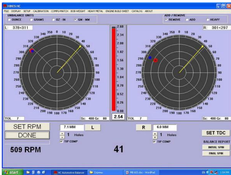
Рис. 3. Полученные данные по дисбалансу коленчатого вала после предварительного измерения
