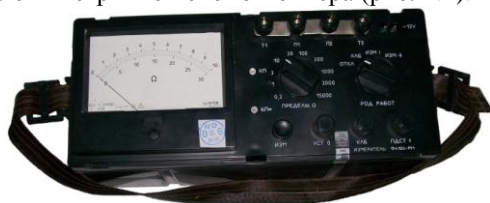
Рис. 4.4. Измеритель сопротивления заземления типа Ф4103-М1
