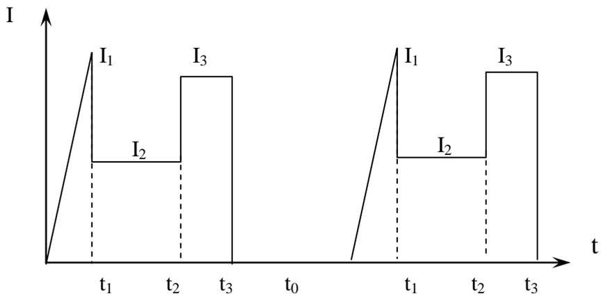
5. Определить мощность двигателя, работающего по графику:
