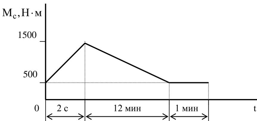
3. Рассчитать мощность двигателя центробежного насоса водоснабжающей установки, нагрузочная диаграмма которого дана:  $P_1 = 1,5\text{кВт}$ ;  $P_2 = 2,0\text{кВт}$ .
