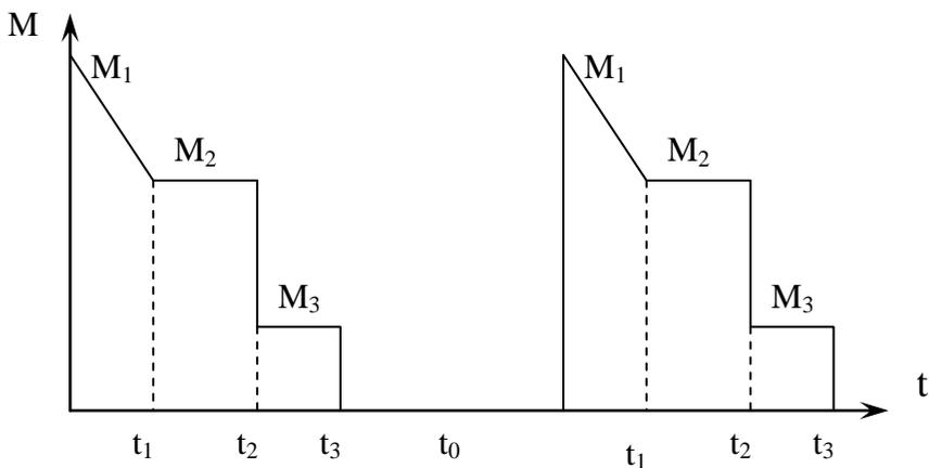
3. Определить мощность двигателя, работающего по графику:
