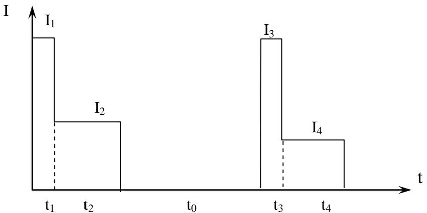
7. Определить мощность двигателя, работающего по графику:
