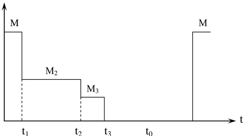
2. Определить мощность двигателя, работающего по графику:
