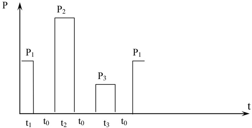
8. Определить мощность двигателя, работающего по графику:
