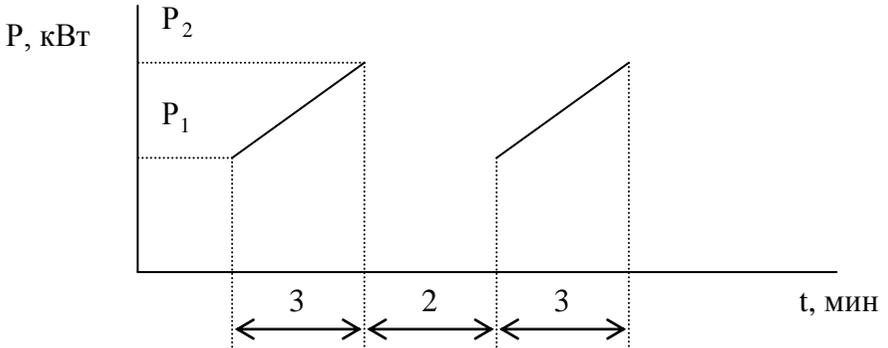
4. Рассчитать мощность двигателя рабочей машины, нагрузочная диаграмма которой приведена. Рабочая скорость агрегата 900 об/мин.
