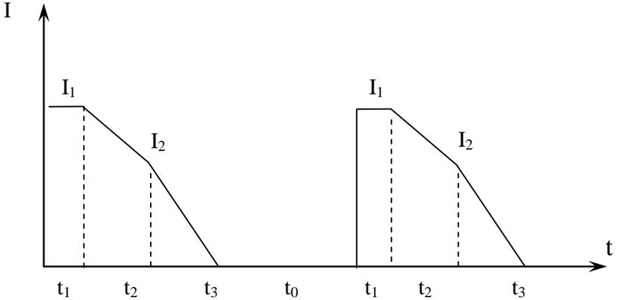
10. Определить мощность двигателя, работающего по графику:
