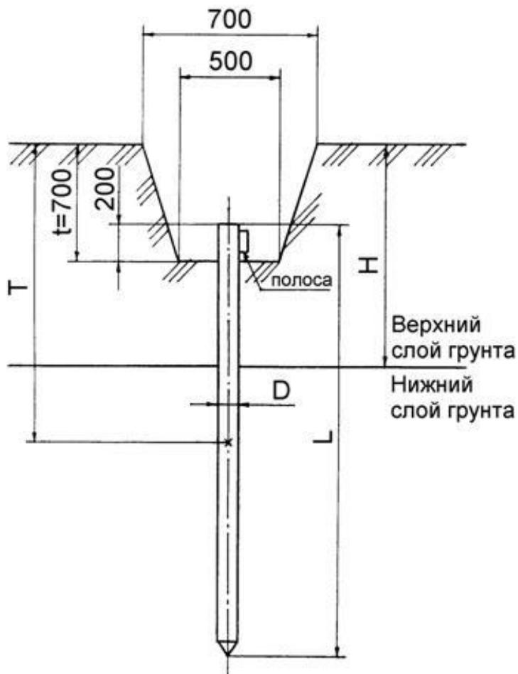
Рис. 7.1 Общий вид вертикального заземлителя.
