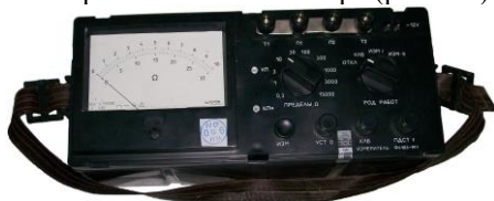
Рис. 4.4. Измеритель сопротивления заземления типа Ф4103-М1
