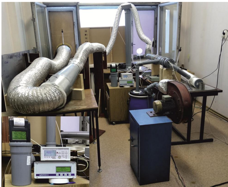
Рисунок 3.4 - Экспериментальный стенд по испытаниям озонатора СФНЦА РАН
