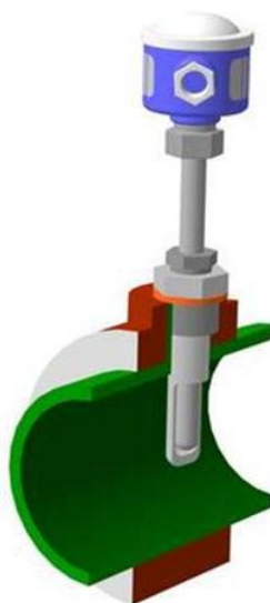
Рисунок 2.7-Монтаж термометра сопротивления на трубопроводе
