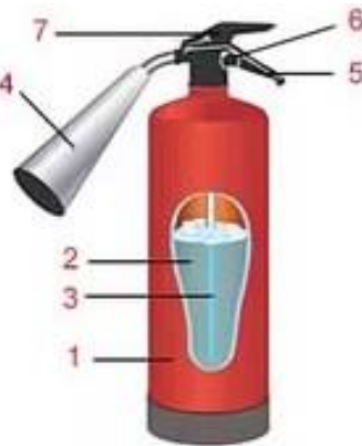
Рис. 5. Конструкция переносного углекислотного огнетушителя:
