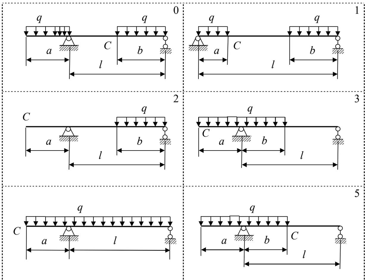
Рисунок 14 – Схема балки к задаче 6.3
