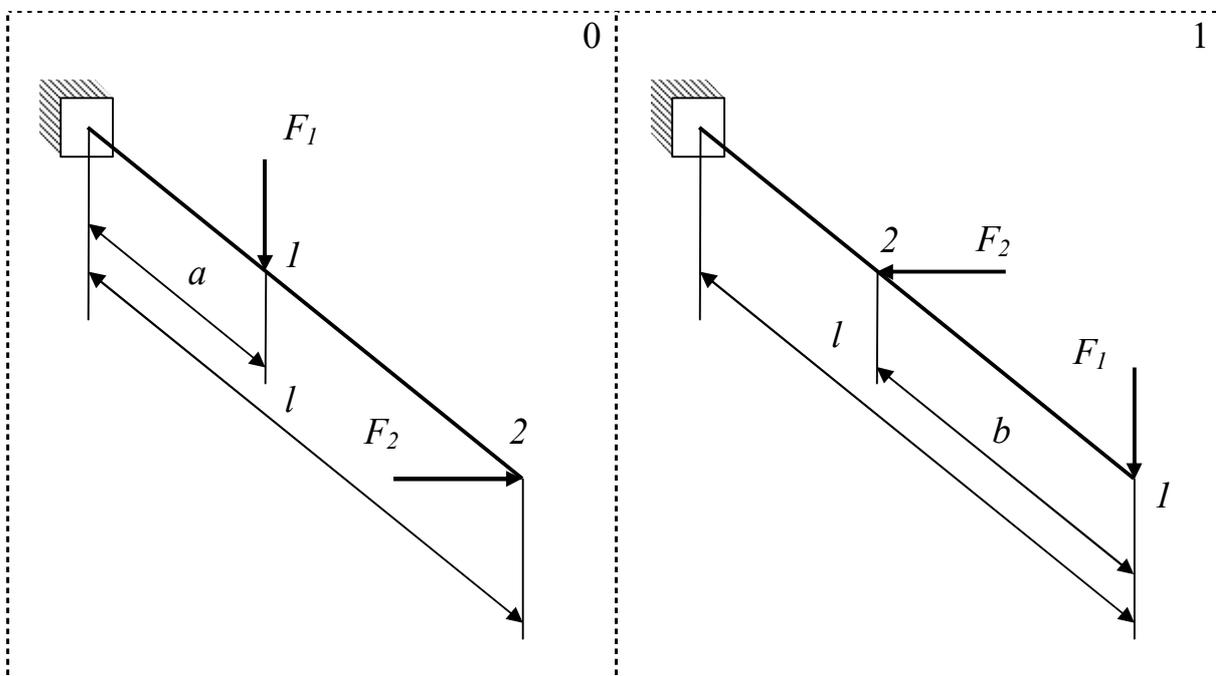
Рисунок 16 – Схема балки в аксонометрии к заданию 8
