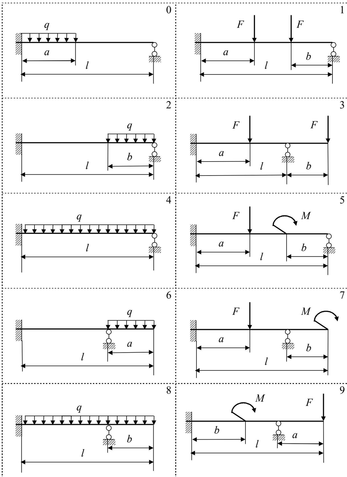
Рисунок 15 – Схема балки к заданию 7
