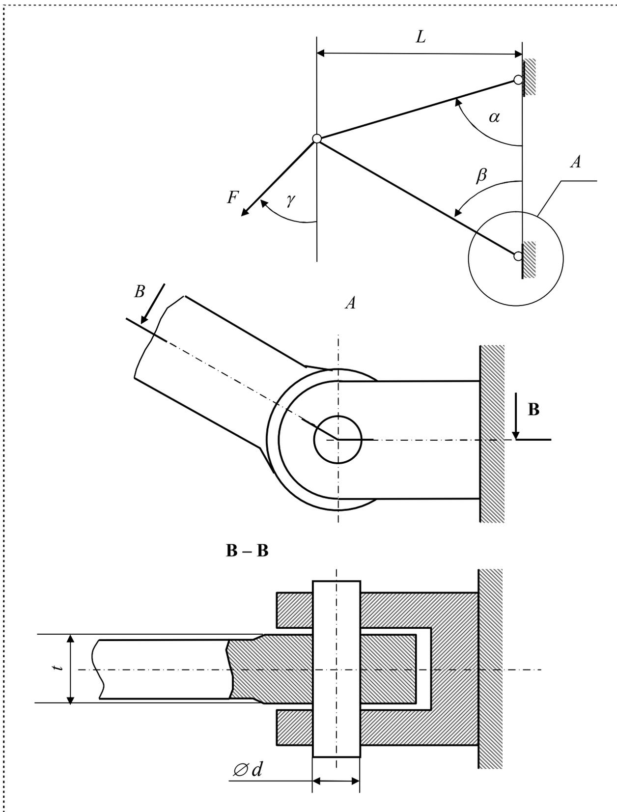
Рисунок 21 – Схема плоской фермы и цилиндрического шарнира
