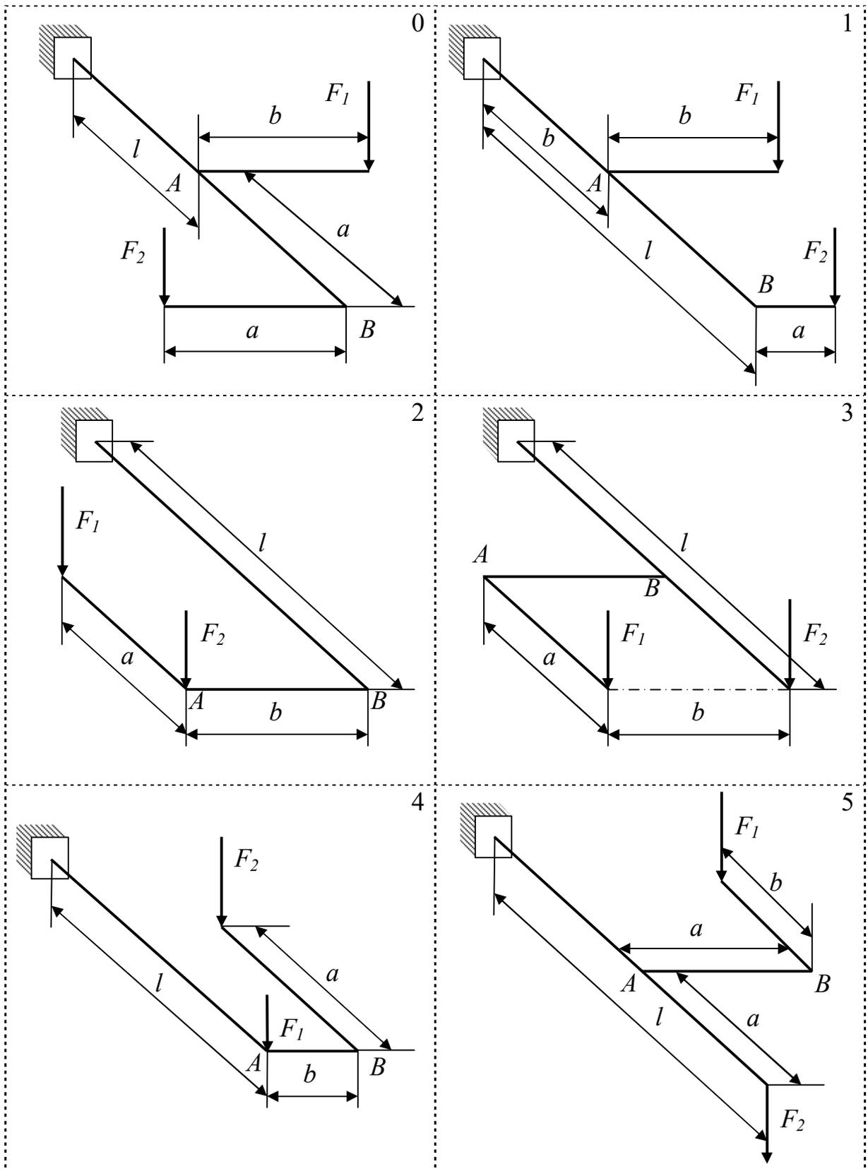
Рисунок 17 – Схема рамы в аксонометрии к заданию 9
