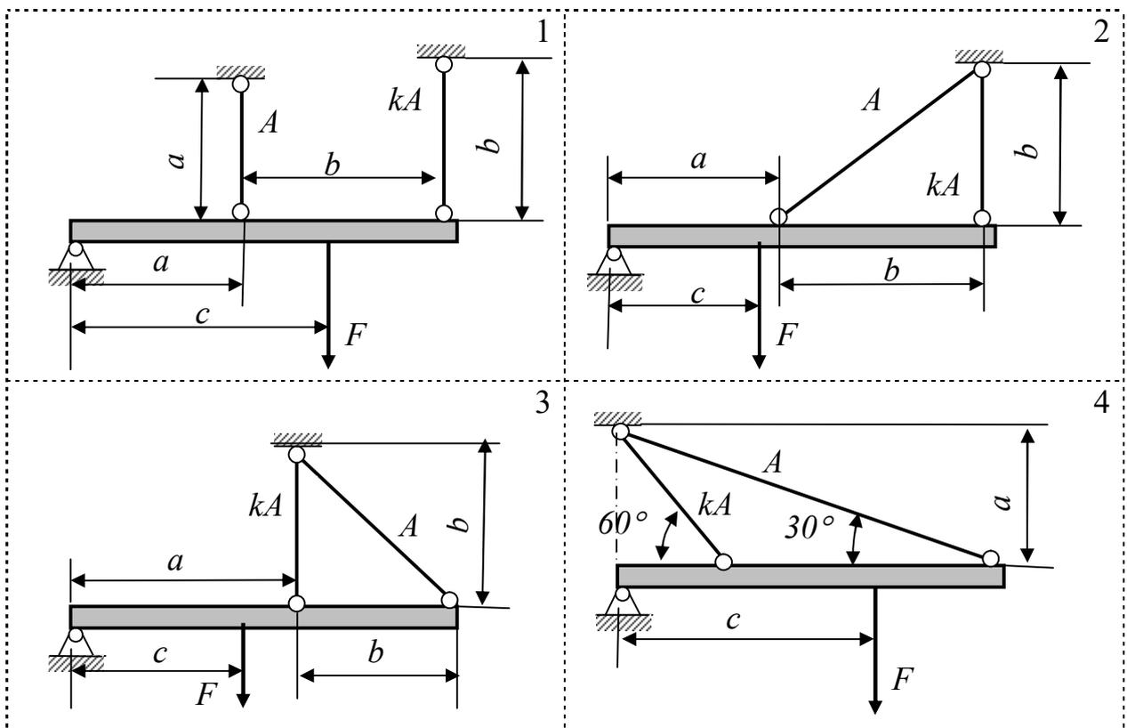
Рисунок 23 – Схема статически неопределимой конструкции
