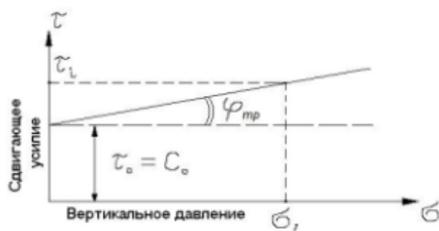
Рис. 2.2. График зависимости сопротивления сдвигу от вертикальной нагрузки
