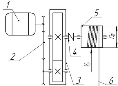
*Рис. 9. Схема привода лебедки:*
