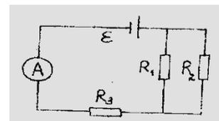
Мощность, выделяемая на сопротивлении  $R_1$ , 1 Вт. Сопротивлением амперметра пренебречь.
