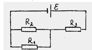
320. ЭДС элемента 12 В. При внешнем сопротивлении 1,1 Ом сила тока в цепи 6 А. Найти падение потенциала внутри элемента и его внутреннее сопротивление.
