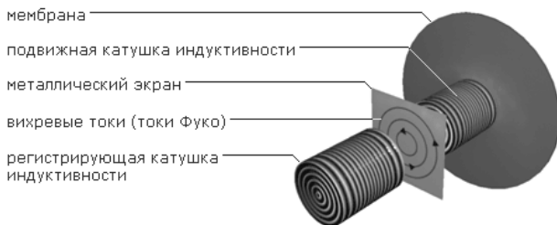
Рис. 1.5.1 – Принципиальная схема индукционного преобразователя давления
