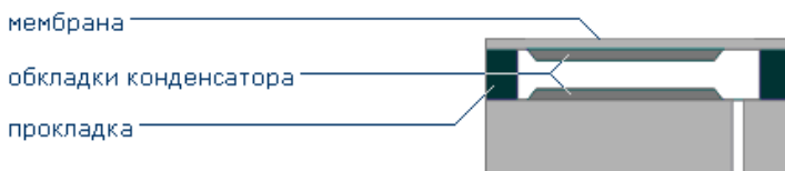
Рис. 1.3.1 – Емкостный преобразователь давления. В данном варианте роль подвижной обкладки конденсатора выполняет металлическая диафрагма
