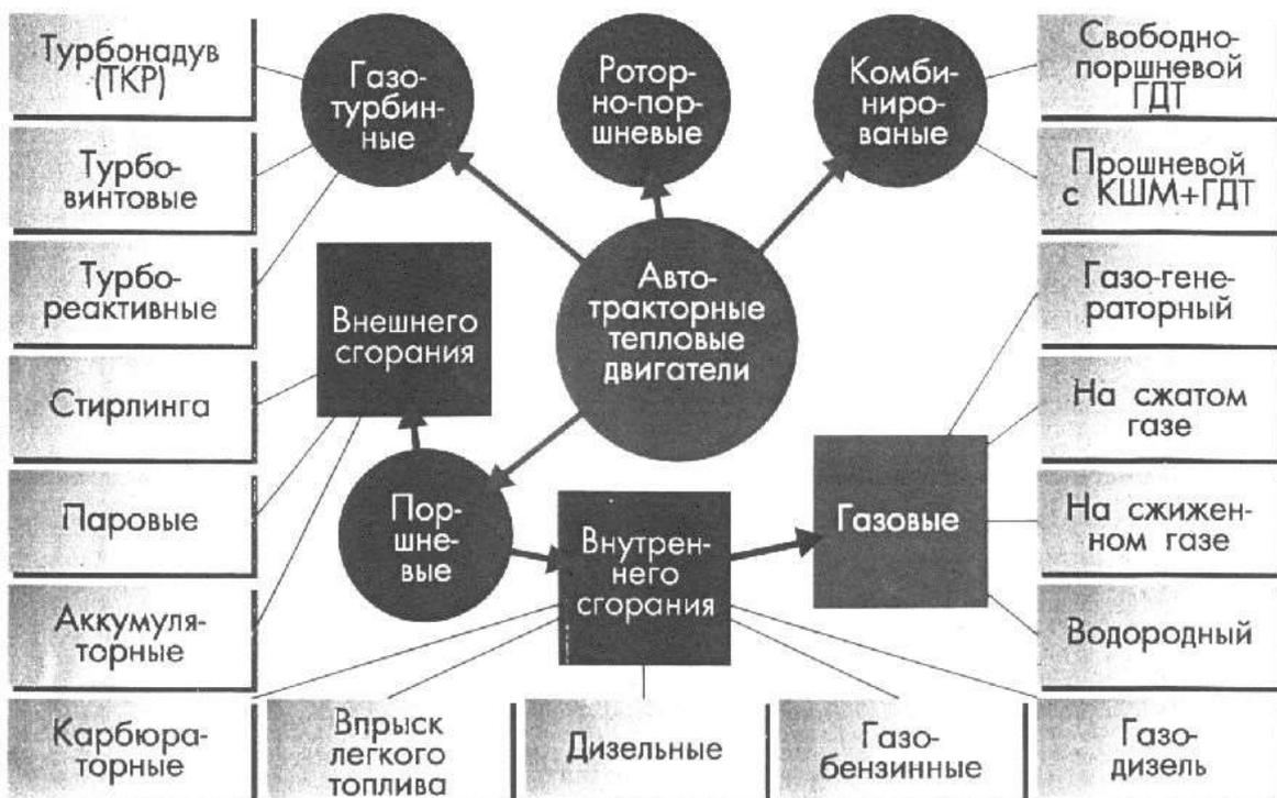
Рис. 1 - Классификация автотракторных тепловых двигателей.
